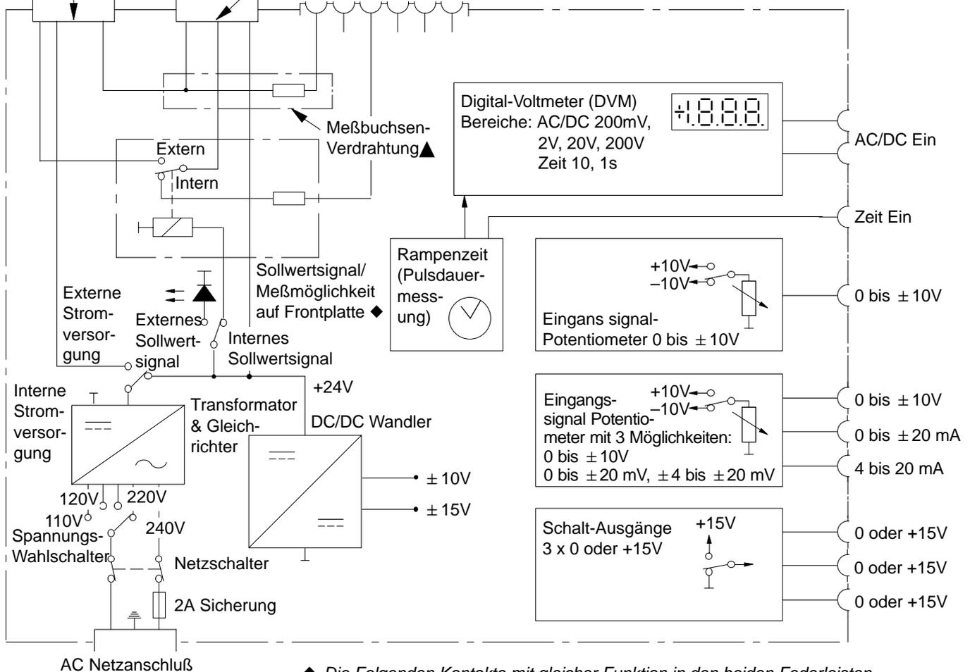
◆ Die Folgenden Kontakte mit gleicher Funktion in den beiden Federleisten und den Meßbuchsen sind intern verbunden wie im Schaltplan gezeigt.
