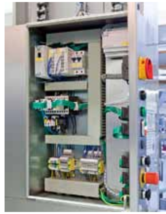
Auch die Verdrahtung der Bedienelemente ist einfach über SmartWire-DT möglich, eine grüne Lampe an jedem Teilnehmer zeigt die Betriebsbereitschaft an
