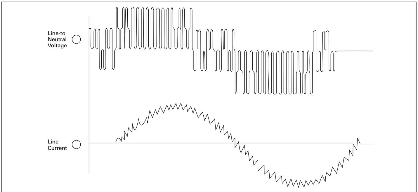
**FIGURE 4. TYPICAL PWM VOLTAGE AND CURRENT WAVEFORMS**
