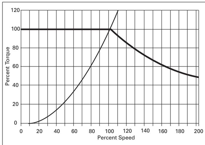
FIGURE 13. SPEED VS. AC DRIVE + MOTOR TORQUE
