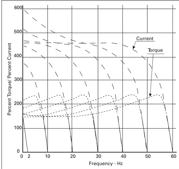
**FIGURE 8. SPEED/TORQUE AND SPEED/CURRENT CURVES**
