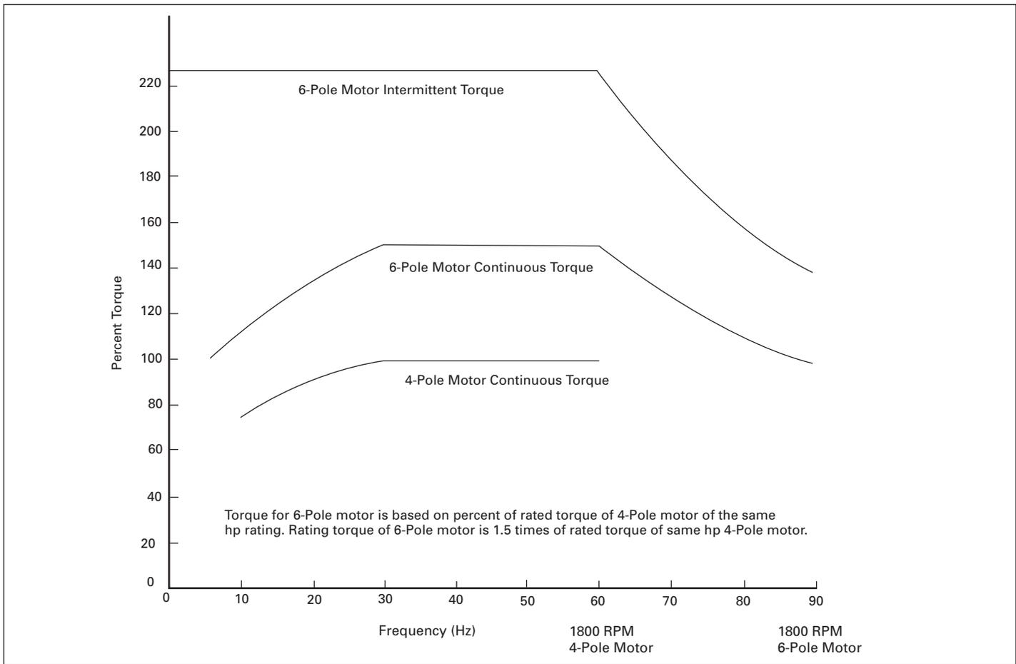
**FIGURE 11. TORQUE SPEED CHARACTERISTICS FOR EXTENDED MOTOR PERFORMANCE**
