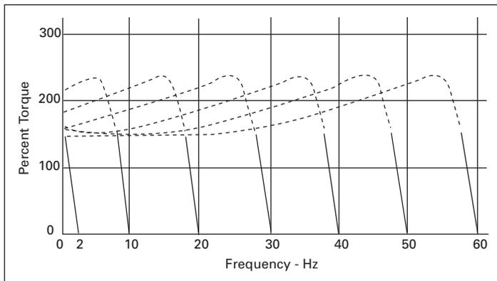
**FIGURE 6. FAMILY OF IDEAL SPEED/TORQUE CURVES**
