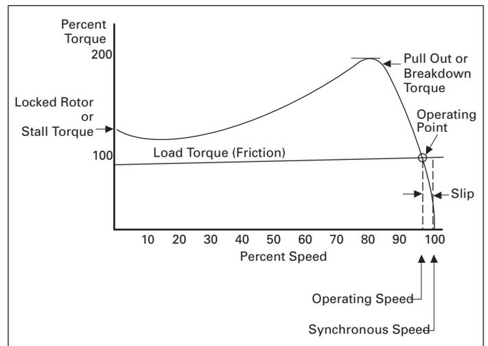
**FIGURE 5. NEMA DESIGN B MOTOR SPEED/TORQUE CURVE**
