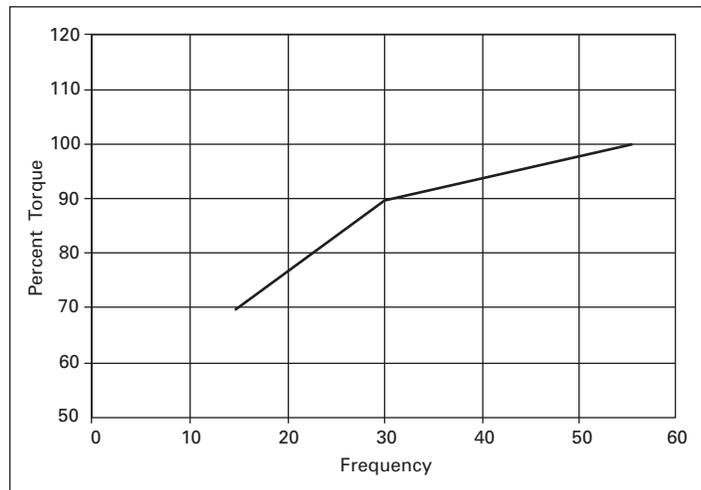
**FIGURE 12. MOTOR TORQUE DE-RATING**
