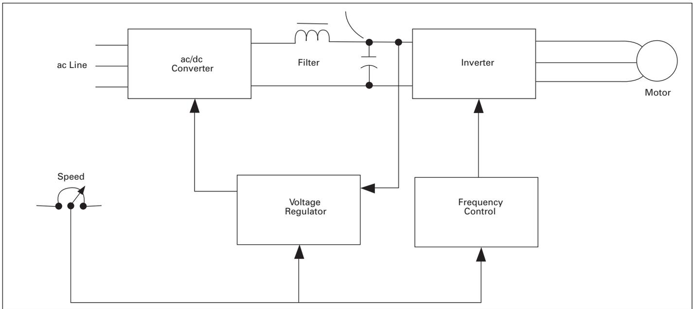
**FIGURE 1. TYPICAL VVI DRIVE BLOCK DIAGRAM**
