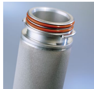
Le cartucce filtranti BECO PROTECT KM , in acciaio inox sinterizzato, vengono impiegate soprattutto nella filtrazione di vapore per la separazione di particelle di ruggine o da abrasione.
