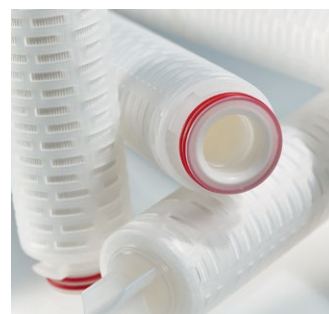
Cartucce filtranti a membrana BECO pieghettate con integrità controllabile, realizzate in polivinilidene fluoruro (PVDF) o polietilene sulfone (PES).
