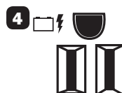
4 Prises protégées par batterie de secours ou protégées contre des surtensions transitoires
