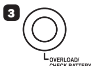
3 Voyant DEL « SURCHARGE/ CONTRÔLE DE BATTERIE »
