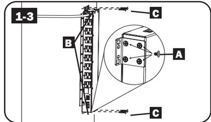
**1-4 Montaje bajo el escritorio:** Use 4 tornillos **A** para instalar cada uno de los 2 soportes de instalación **B** al PDU como se muestra. Monte el PDU bajo el escritorio insertando 2 o más tornillos, suministrados por el usuario **C** a través de los soportes de montaje **D** y en puntos de montajes seguros.
