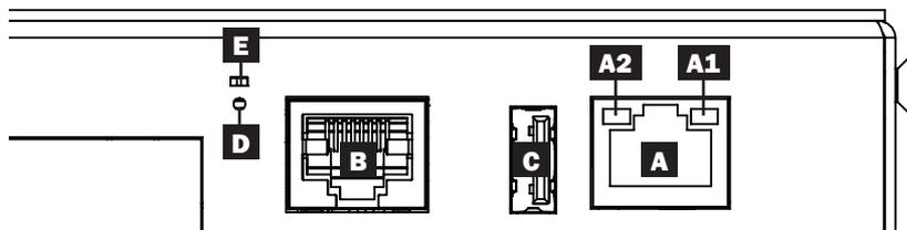
**A Port Ethernet :** Utiliser cette prise RJ45 pour connecter la WEBCARDLX au réseau avec un cordon de raccordement Ethernet standard. Voyants à DEL **A1** et **A2** indiquent les conditions de fonctionnement (affichées dans le tableau ci-dessous).
