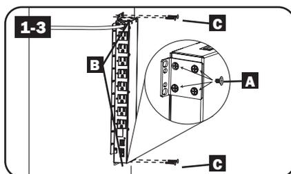
**1-4 Montage sous comptoir :** Utiliser 4 vis **A** pour fixer chacun des 2 supports de fixation **B** à la PDU tel qu'illustré. Montez l'unité de distribution sous le comptoir en insérant 2 vis (ou plus, fournies par vous) **C** dans les supports de fixation **D** et dans des points de montage solides.
