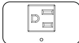
**Receptáculos de salida NEMA 5-15/20R (PDUMH20NET2):** Durante la operación normal, los receptáculos de salida distribuyen la energía de CA al equipo conectado. Cuando una salida está viva se ilumina el LED asociado.
