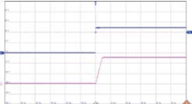
Ch1: Input voltage (5 V/div.) Time scale: (10 ms/div.) Ch2: Output voltage (2 V/div.)
