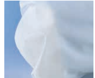
Voile extérieure en maille polyamide 6.6 de 10 µm
