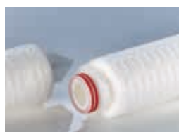
Kod 2: Otwarty jednostronnie (SOE), o-ring 2-222, potrójny adapter bagietkowy z elementem centrującym, średnica zewnętrzna 44 mm (w najniższym punkcie)
