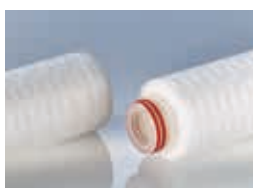
Kod 0: Otwarty jednostronnie (SOE), o-ring 2-222 bez elementu centrującego, średnica zewnętrzna 44 mm (w najniższym punkcie)
