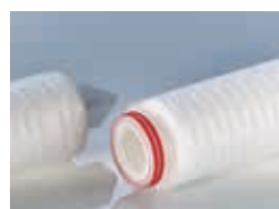
Kod 7: Otwarty jednostronnie (SOE), o-ring 2-226, podwójny adapter bagietkowy z elementem centrującym, średnica zewnętrzna 56 mm (w najniższym punkcie)
