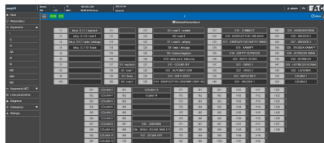
Rys. 11: Webserver – podgląd sygnałów wejściowych do sterownika easyE4
