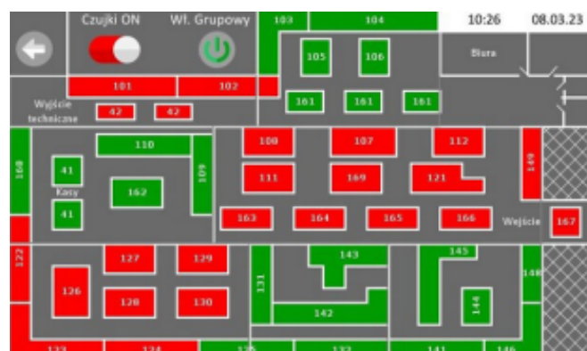
Rys. 5: Wizualizacja z panelu HMI – widok po wybraniu opcji SZYBKA EKSPOZYCJA z menu
