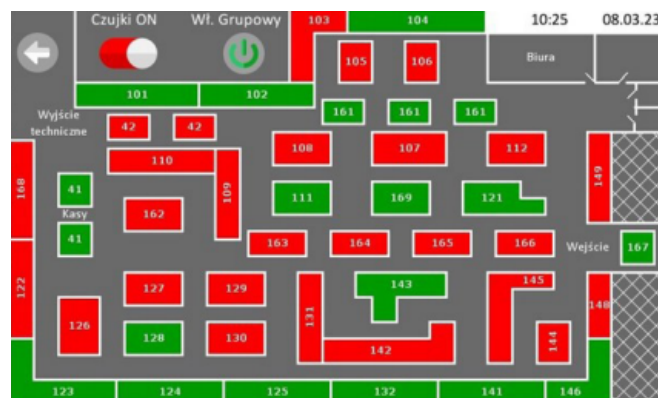
Rys. 4. Wizualizacja z panelu HMI - sterowanie ekspozytorami. Widok po wybraniu opcji EKSPOZYCJA z menu
