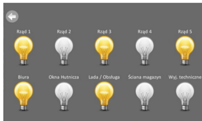
Rys. 3: Wizualizacja z panelu HMI – sterowanie oświetleniem po wybraniu opcji z menu OŚW. GŁÓWNE
