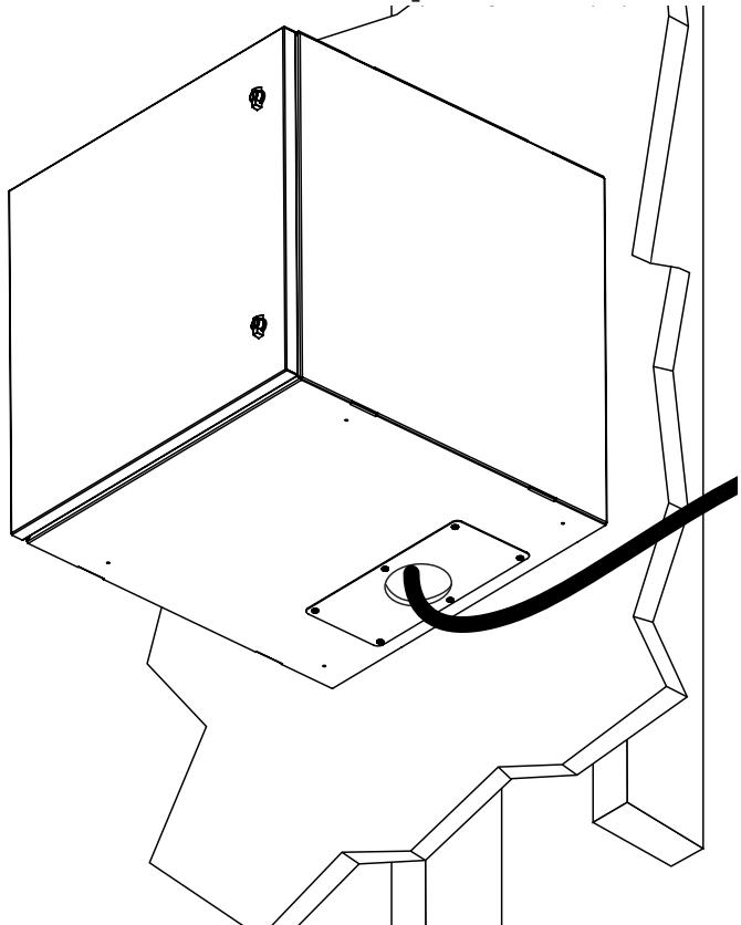
**Nota:** Para mantener una especificación NEMA, utilice accesorios sellados en los recortes al conectar a conductos.
