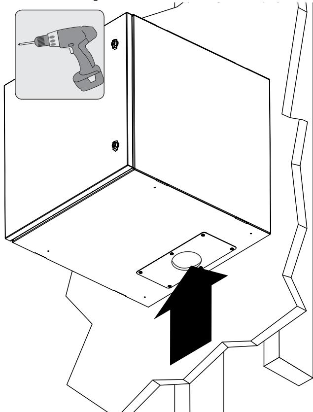
**Nota:** Esta tapa de conductos soporta un tamaño comercial máximo de conductos 2 con orificio de 2.5".
