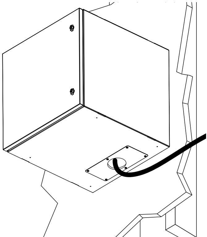
**Remarque :** Pour garder une capacité nominale NEMA, utiliser des raccords étanches dans les découpes au moment de connecter à la conduite.
