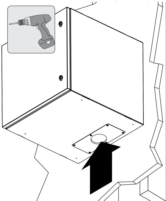
**Remarque :** Ce couvercle de conduit prend en charge un conduit de taille 2 maximum avec un trou de 2,5 po.
