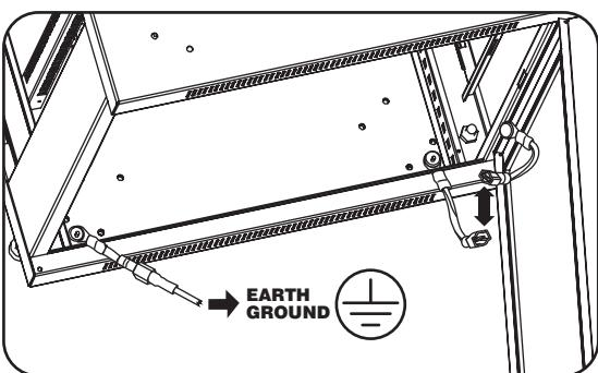
**Advertencia:** Conecte cada rack a tierra por separado. No use el rack sin una conexión a tierra.
