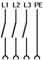
Anschlussbild Flanschsteckdose, GHG 511 und GHG 512 / Contact arrangement Flange socket, GHG 511 and GHG 512 / Disposition des contacts / Prise à bride, GHG 511 et GHG 512
