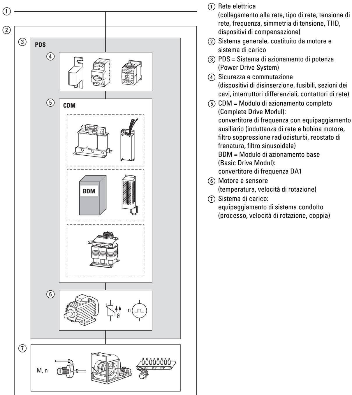
Figura 24: Esempio per un sistema di azionamento (sistema generale come impianto o parte di un impianto)
