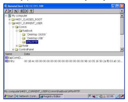
Der Export-Taster öffnet das "Save as" Fenster um die Werte von VPN-PPTP in einem Registry-File zu speichern (z.B. VPN-PPTP.reg).
