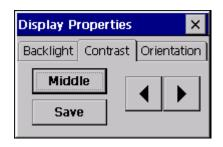
Dieses Programm dient zur Einstellung des Bildschirmkontrastes. Mit «Middle» wird der werkseitig abgespeicherte Mittelwert eingestellt. Mittels «Save» wird die gewählte Einstellung persistent abgespeichert, d. h. sie bleibt auch nach einem Neustart erhalten.
