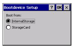
BootDevice Setup dient dazu, anzugeben von welchem Medium das Panel gestartet werden soll. Je nach Ausstattung des Panels werden die entsprechenden Auswahlmöglichkeiten angezeigt.
