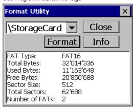
Im linken oberen Auswahlfeld kann das Flashkartenlaufwerk ausgewählt werden. Im unteren Anzeigefeld werden die Informationen zum ausgewählten Laufwerk angegeben. U. a. sind dies Angaben wie FAT Typ, Gesamtspeichergrösse, momentan verwendeter Speicher, usw. Viele der Informationen werden im Normalfall nicht benötigt.
