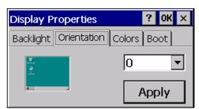
Mittels der Einstellungen «0» (Standardeinstellung) oder «90» kann die Ausrichtung eingestellt werden. Die Drehung erfolgt im Uhrzeigersinn. Wobei die Einstellung «90» für den hochkantigen Einbau gewählt wird. Das Bild links im Dialog zeigt die eingestellte Ausrichtung. Die Einstellung wird erst nach einem Neustart übernommen.
