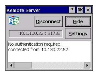
Mittels «**Hide**» kann der Dialog minimiert werden, d. h. es ist nur noch das Icon sinnerhalb der Startleiste sichtbar. Beim Betätigen der Taste «**Disconnect**» wird die aktuelle Client/Server Verbindung geschlossen. Über «**Passwort Settings**» können die <u>Passworteinstellungen</u> verändert werden.
