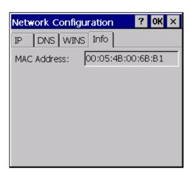
Innerhalb der Infoseite wird die MAC-Adresse des HMI Gerätes angezeigt. Es handelt sich hierbei um eine herstellerspezifische, weltweit einzigartige Nummer für den Ethernetanschluss des Gerätes.
