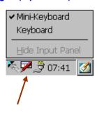
Um die Zeicheneingabe am Gerät zu ermöglichen, stehen verschiedene Software-Tastaturen zur Verfügung. Mit der Einstellung «Input Panel active» kann die Software-Tastatur aktiviert bzw. deaktiviert werden. Standardmässig ist die Option deaktiviert. Eine Veränderung dieser Einstellung bedingt einen Neustart des Systems.
