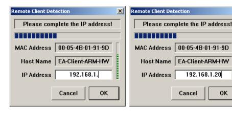
Nach dem Drücken der OK-Taste wird die vollständige IP Adresse vom "Remote Client" DHCP Server übernommen. Bei der nächsten DHCP Anfrage vom Gerät wird diesem die IP Adresse mitgeteilt. Der "Remote Client" DHCP Server wartet anschliessend auf die Bestätigung vom Gerät, dass die erhaltene IP Adresse akzeptiert wurde.
