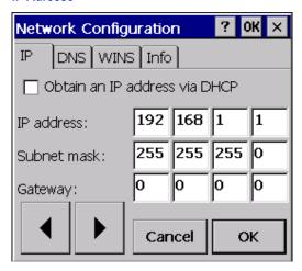
Grundsätzlich besteht die Möglichkeit, dass das Gerät beim Starten eine IP Adresse (Netzwerkadresse) von einem DHCP Server erhält «**Obtain an IP address via DHCP**». Um das Gerät jedoch eindeutig zu identifizieren, sollten Sie die Methode «**Specify an IP address**» wählen.
