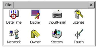
Die Einstellungen für Datum/Zeit, Display und Touch sind von Werk aus bereits optimal eingestellt. Die Netzwerkeinstellungen jedoch müssen zwingend mit Ihrem Netzwerk abgestimmt werden.
