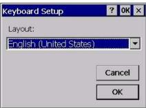
Das Keyboard Setup – Kontrollpanel nimmt die Ländereinstellung für eine USB-Tastatur vor. Innerhalb des oben abgebildeten Dialoges können Sie das gewünschte Tastatur-Layout auswählen. Das eingestellte Tastatur-Layout bleibt auch nach einem Neustart erhalten.
