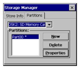
Beim Erstellen einer neuen Partition kann der maximal verfügbare Speicherplatz verwendet werden oder die Grösse kann in Anzahl Sektoren angegeben werden. Die Umrechnung von MB in Sektoren erfolgt wie folgt:
