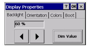
Mittels dieses Programms kann die Hintergrundbeleuchtung auf den gewünschten Wert eingestellt werden. Die gewählte Einstellung wird persistent abgespeichert, d. h. sie bleibt auch nach einem Neustart erhalten.
