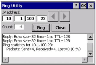
Innerhalb des Dialoges lässt sich die IP-Adresse und die Anzahl «Pings» einstellen. Das Resultat der Pings wird im Anzeigefeld ausgegeben.
