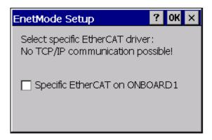
Hier kann konfiguriert werden, dass die Ethernetschnittstelle als EtherCAT Schnittstelle genutzt wird. Ist die Schnittstelle im EtherCAT Modus, kann keine TCP/IP Kommunikation über diese Schnittstelle stattfinden!
