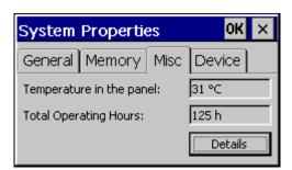
Im Register «MISC» wird die aktuelle Temperatur und die Betriebsstunden angezeigt.
