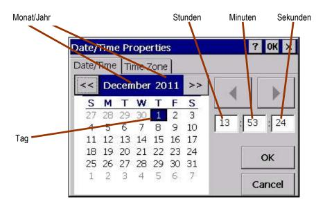
Monat und Jahr verändern Sie über die beiden angegebenen Tasten (<< und >>). Den Tag wählen Sie direkt durch Berührung des Monatstages. Stunden, Minuten und Sekunden werden nach Anwahl durch die oben liegenden Tasten geändert. Stunden sind im 24 h Format anzugeben. Durch Betätigen von «OK» werden die aktuellen Einstellungen im Uhrenbaustein abgespeichert und bleiben auch bei einem Neustart erhalten.
