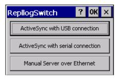
Das Programm «Repllogswitch.exe» dient zur Verbindungsaufnahme mittels ActiveSync oder «Manual Server» zu einem PC. Das Vorgehen ist den Kapitel <u>Vorgehen: ActiveSync</u> resp. <u>Vorgehen: Manual Server</u> zu entnehmen.
