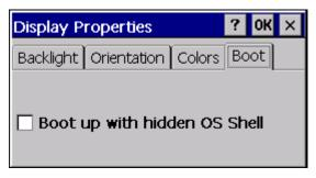
Mittels dieser Einstellung kann das Aufstartverhalten des Gerätes beeinflusst werden. Ist die Option aktiviert, so wird während dem Gerätestart anstelle der Windows CE Oberfläche entweder das Bitmap Autoexec.bmp oder ein schwarzer Bildschirm angezeigt. Auch die Ausführung der Datei Autoexec.bat ist nicht sichtbar.
