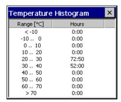
Unter **Details** werden die Anzahl Betriebsstunden, in einzelne Temperaturbereiche aufgeschlüsselt, angezeigt:
