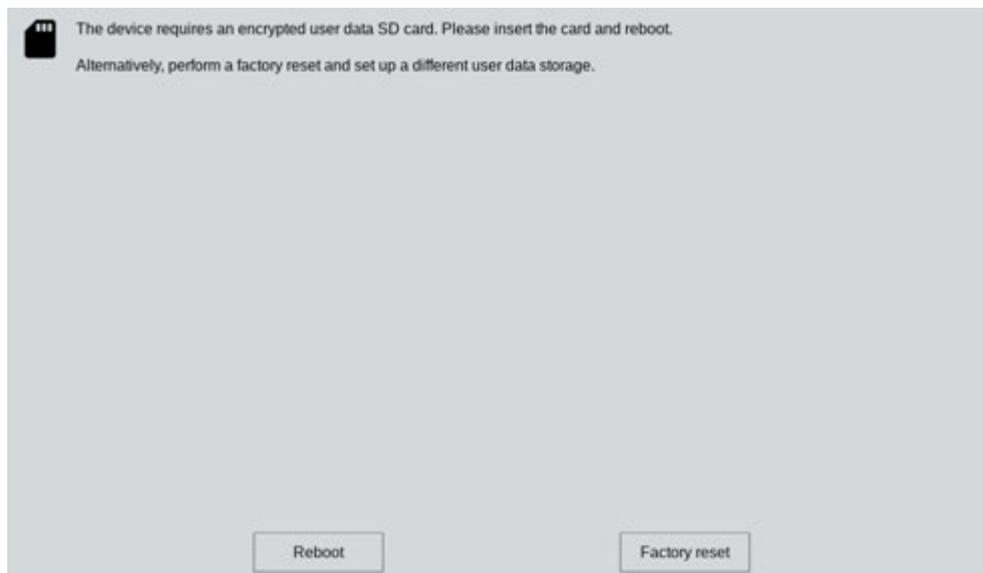
Dann entweder die passende SD-Karte stecken und das Gerät mit **Reboot** neu starten oder mit **Factory reset** das Gerät auf Werkseinstellungen zurücksetzen.
